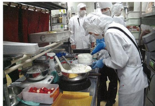
図1●生菓子を生産する一人屋台 以前は、「スポンジを切る人」「スポンジに生クリームを塗る人」「飾り付けをする人」といった具合に分業していたが、今では1人で生ケーキの仕上げ作業をしている（写真の写る中央奥の人たちはカイゼン指導会の参加者）。現在、特定の店舗で売れるケーキは全て、この屋台で作ることを目指して奮闘中。実現すれば、将来、店舗に屋台を移設し、顧客の顔を見ながら店頭で造ることも検討している。
